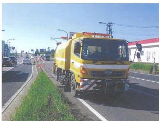
<多車線道路での路面清掃>
