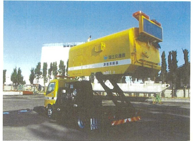
リフトした状態 地上面からホッパ後部下面までの高さは2,050mm
