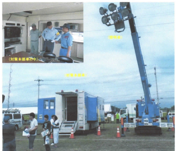
災害本部車の拡幅設置状況(左)と照明車の設置状況
